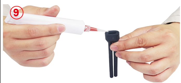
9: 将硅树脂(室温硫化)注入硅胶套的电线输入孔里。
